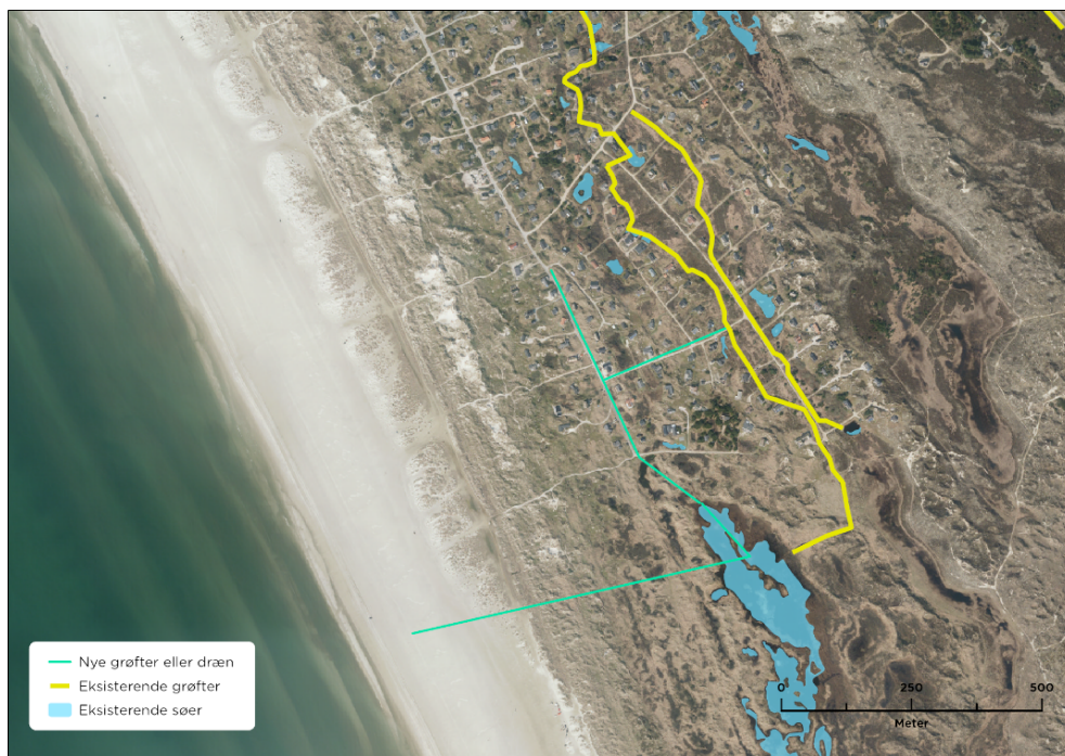
Figur 3-1. Rindby Strand. Placering af grøfter i det sydlige del af området.
