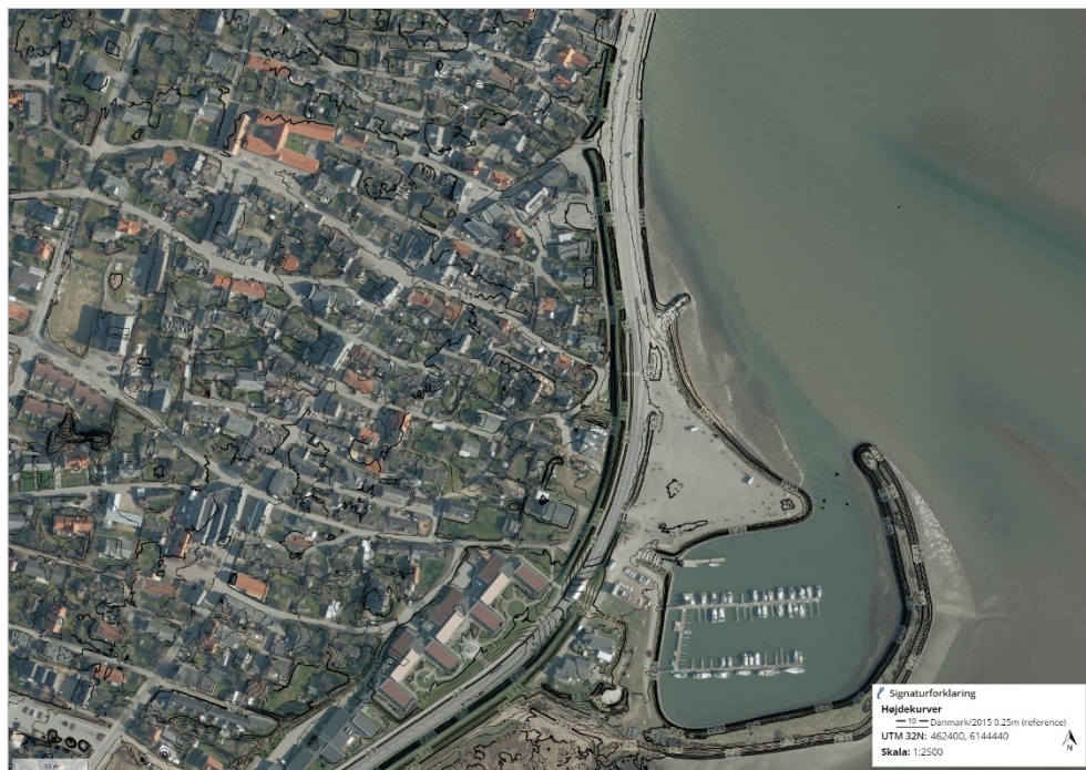
Figur 9-3. Nordligste del af det sydlige dige om Nordby. Med sort er angivet højdekurver med 0,25 m. ækvidistance.
